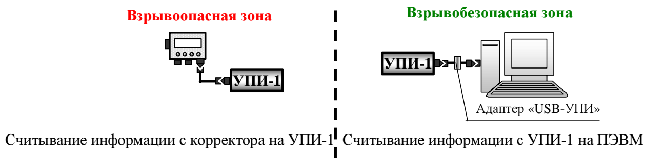
Рисунок 54 - Считывание информации с УПИ-1 на ПЭВМ через USB-порт
